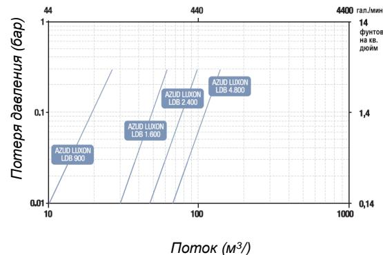
Характеристики потока в зависимости от условий фильтра, частота активации процедуры промывки. Данные для фильтров до 125 микрон и воды хорошего качества.
